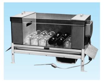
放射性炭素  $(C_{14})$  を用いて海洋、湖沼などの生産量を測定するために用いられます。生産量とは、海洋、湖沼中で一定期間に生産される有機物量のことで、主として植物プランクトンによって行なわれる生産量、即ち炭素同化作用量を基礎生産量といいます。
